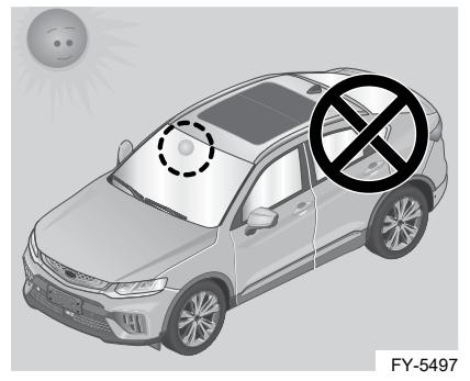
1. Не храните горючие вещества в автомобиле. Горючие и взрывоопасные предметы (зажигалки и т. д.) могут взорваться из-за высокой температуры окружающей среды и, таким образом, стать причиной пожара.
