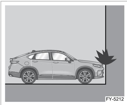
При фронтальном столкновении автомобиля со стеной на скорости более 25 км/ч срабатывают передние подушки безопасности.
