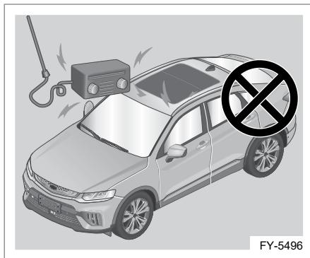
4. При установке мультимедийной системы и добавлении проводов тепло, выделяемое в местах соединения проводов разного сечения, может привести к возгоранию.
