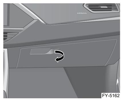
Перчаточный ящик расположен на приборной панели со стороны переднего пассажира. Для открывания перчаточного ящика потяните ручку влево. Для закрывания перчаточного ящика нажмите на его крышку.
