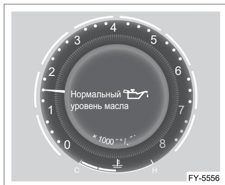
Датчик уровня моторного масла передает показания уровня моторного масла на комбинацию приборов; это значение отображается на дисплее комбинации приборов в режиме реального времени. Уровень моторного масла можно проверить в интерфейсе маршрутного компьютера на комбинации приборов, а функцию отображения уровня масла можно включить или отключить, выбрав «Бортовой компьютер» — «Уровень моторного масла».
