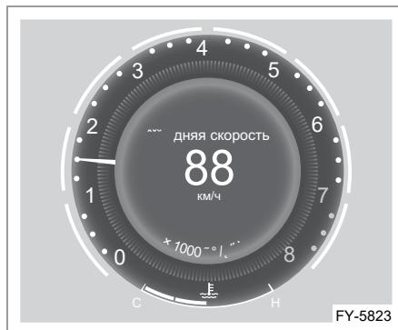
Отображаемый диапазон средней скорости автомобиля составляет 0–240 км/ч; значение «240 км/ч» отображается, когда скорость превышает 240 км/ч. Расчет начинается после запуска двигателя и прохождения определенного расстояния;
