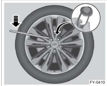
2. Достаньте пластиковые плоскогубцы из набора инструментов, зажмите ими колпачок накладки колесной гайки, как показано на рисунке, и потяните накладку наружу.
