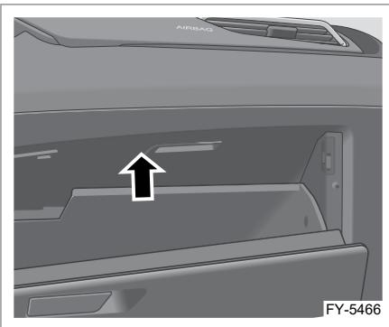
Фильтр системы кондиционирования расположен за перчаточным ящиком. Фильтр способен удалять пыль, пыльцу и другие мельчайшие частицы (размером 0,3 мкм) из воздуха, поступающего снаружи в салон автомобиля, а также имеет функцию обеззараживания.
