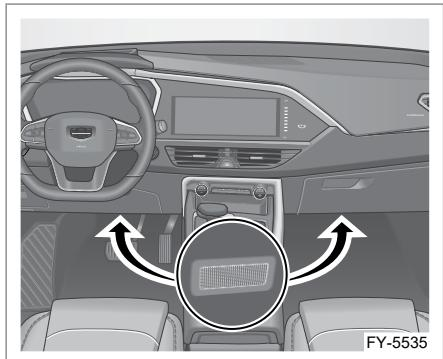
Лампы подсветки пространства для ног установлены на нижней декоративной накладке приборной панели над ногами водителя и переднего пассажира.
