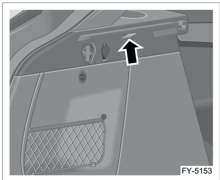
Лампы освещения багажного отделения расположены на внутренних декоративных накладках с обеих сторон багажного отделения. Данные лампы загораются автоматически при открывании двери багажного отделения.
