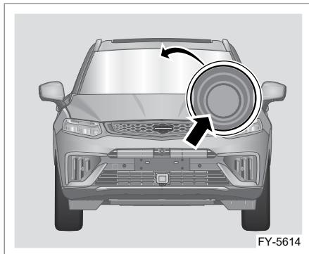
Фронтальная камера установлена за ветровым стеклом автомобиля. Фронтальная камера является основным компонентом системы интеллектуального круиз-контроля (ICC), системы автоматического экстренного торможения (AEB), системы удержания в полосе движения (LKA), системы информирования об ограничении скоростного режима (SLIF) и системы интеллектуального управления дальним/ближним светом фар.
