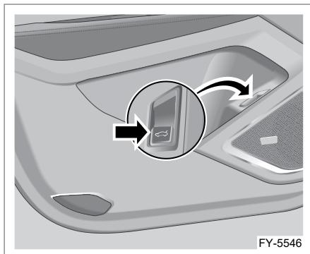
Когда автомобиль остановлен, потяните переключатель электропривода двери багажного отделения вверх — дверь багажного отделения автоматически откроется; нажмите и удерживайте переключатель электропривода двери багажного отделения — дверь багажного отделения закроется; отпустите переключатель электропривода двери багажного отделения — дверь багажного отделения перестанет закрываться.
