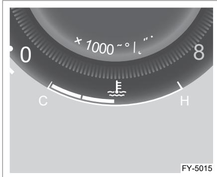
Верхний предел температуры охлаждающей жидкости двигателя обозначен символом «Н», а нижний – символом «С».
