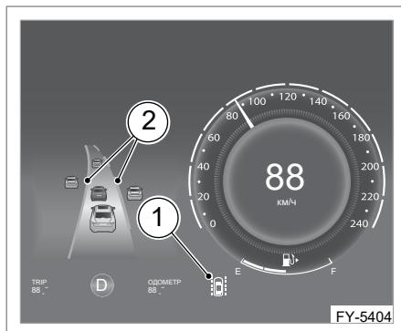
Когда активирована функция предупреждения о выходе из полосы движения или система удержания в полосе движения, значок (1) системы LKA становится зеленым; при отказе функции предупреждения о выходе из полосы движения или системы удержания в полосе движения значок (1) системы LKA становится красным.
