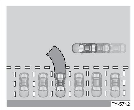
Если во время движения задним ходом система обнаружит, что существует риск столкновения между движущимся автомобилем и транспортным средством, приближающимся сбоку, она напомнит водителю о необходимости обратить внимание на дорожную обстановку позади автомобиля путем мигания индикатора предупреждения о появлении транспортного средства в слепой зоне в соответствующем боковом зеркале и подачи звукового сигнала.
