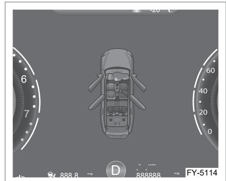
Если после запуска двигателя капот, любая из четырех дверей или дверь багажного отделения не закрыты должным образом, на комбинации приборов появится предупреждающее сообщение и раздастся звуковой сигнал для предотвращения внезапного открытия двери во время движения автомобиля. Когда водительская дверь заперта, а любая другая дверь не заперта, отобразится предупреждающая сигнализация о соответствующей незапертой двери.
