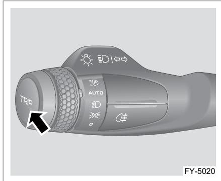
Нажмите кнопку TRIP для циклического переключения информации в интерфейсе маршрутного компьютера.
