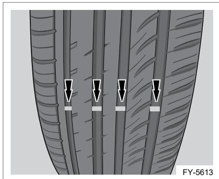
Судить о необходимости замены шин можно по индикатору износа протектора. Индикатор становится видимым в том случае, если остаточная глубина протектора составляет 1,6 мм или менее.
