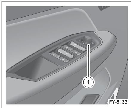
1. Переключатель регулировки положения наружных зеркал заднего вида
