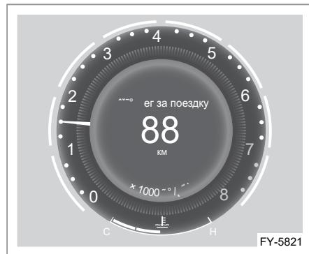
Пробег за поездку показывает расстояние, пройденное автомобилем после последнего запуска двигателя; отображаемый диапазон показаний составляет 0–999,9 км. Данное значение будет автоматически сброшено после выключения двигателя.
