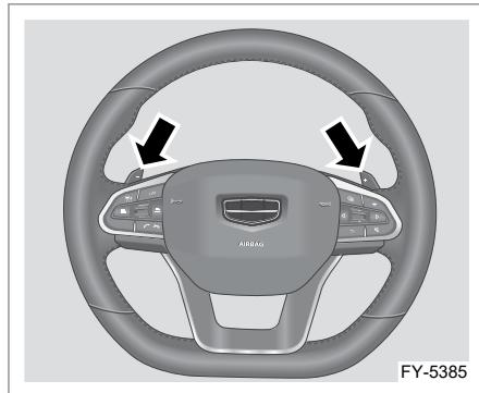
Подрулевые лепестковые переключатели передач находятся сзади кнопок на рулевом колесе.
