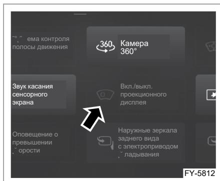
Выключатель проекционного дисплея находится в меню быстрого доступа мультимедийной системы. Нажмите на данный выключатель, чтобы включить или выключить проекционный дисплей.
