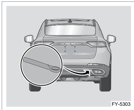
Спереди и сзади автомобиля с правой стороны установлены съемные буксировочные проушины. Буксировочная проушина находится в отсеке с инструментами в багажнике. Место установки буксировочной проушины — в правой части переднего/ заднего бампера автомобиля. Чтобы установить буксировочную проушину, снимите крышку с соответствующего отверстия, затем вверните буксировочную проушину в резьбовую направляющую втулку и полностью затяните ее с помощью ключа для колесных болтов.
