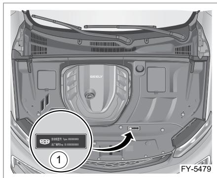
1. Маркировка типа двигателя
