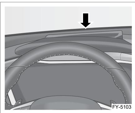
Проекционный дисплей (HUD) установлен на приборной панели перед водителем. Дисплей проецирует виртуальное изображение в нижнюю часть ветрового стекла на расстоянии условно 2 м перед ветровым стеклом. При необходимости водитель может отрегулировать положение дисплея, яркость в вертикальной плоскости, включить или выключить дисплей.
