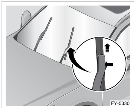
Проверьте щетки стеклоочистителя на наличие износа или трещин. Порядок замены щеток стеклоочистителя:
