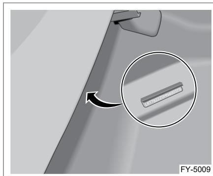
Номер VIN выбит на поперечине под передним правым сиденьем. Номер VIN виден, если отодвинуть переднее правое сиденье назад и приподнять напольное покрытие.
