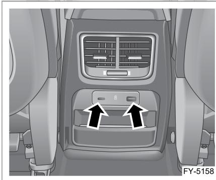
Два USB-разъема располагаются на задней части центральной консоли.
