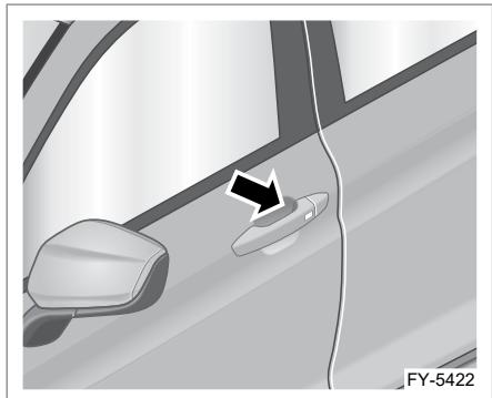
Лампа подсветки расположена с внутренней стороны ручки двери. Когда вы входите в зону приветствия (около 3 метров от автомобиля) или когда автомобиль не заперт, лампа на наружной ручке двери загорится автоматически, чтобы облегчить использование ручки.
