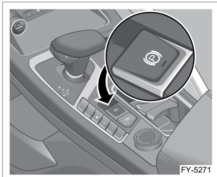
Выключатель электрического стояночного тормоза находится на блоке переключателей центральной консоли.
