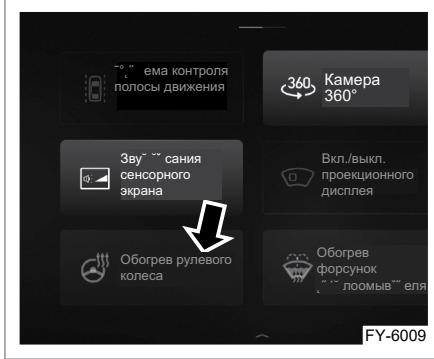
После запуска двигателя функцию обогрева рулевого колеса можно включить, нажав кнопку обогрева рулевого колеса в интерфейсе мультимедийной системы. Работа функции обогрева прекращается при достижении температуры примерно 40 °C. Функцию обогрева также можно отключить с помощью соответствующей кнопки.
