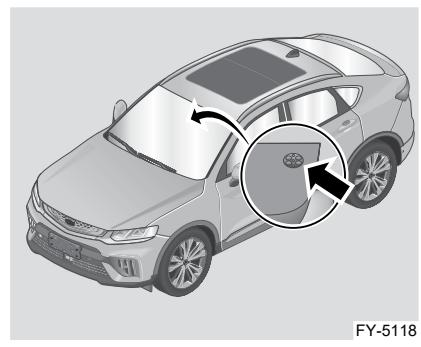
Датчик наружной освещенности и солнечного излучения расположен на внутренней поверхности ветрового стекла.
