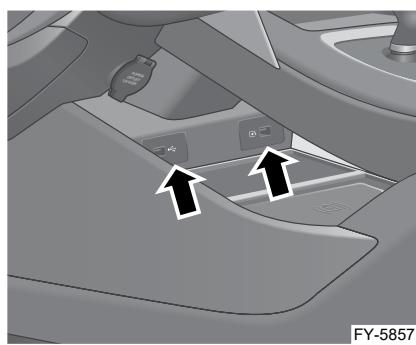
USB-разъемы расположены внизу на передней части центральной консоли.
