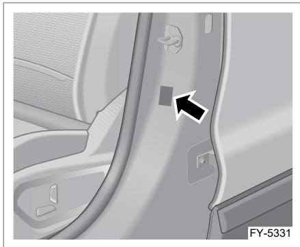
На автомобиле имеется табличка с указанием норм давления воздуха в шинах. Она расположена в нижней части центральной левой стойки с внешней стороны. На табличке указаны значения давления воздуха для передних и задних шин.
