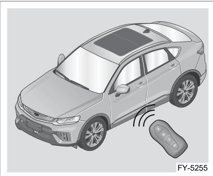
Смарт-ключ работает только в пределах определенного радиуса действия. Помните, что на радиус действия смарт-ключа влияет ряд факторов, таких как наличие других объектов, окружающая среда и т. п. В целях безопасности, запирая двери автомобиля с помощью смарт-ключа, проверяйте результативность этой операции.
