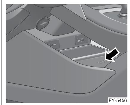
Автомобиль оснащен функцией беспроводной зарядки. Модуль беспроводной зарядки расположен в нижней части центральной консоли. При использовании данной функции убедитесь, что катушка телефона совмещена с катушкой в центре зарядной панели, когда пусковой переключатель установлен в режим АСС/ON. Поскольку расположение катушки мобильного телефона зависит от модели телефона, может потребоваться отрегулировать положение мобильного телефона на зарядной панели.
