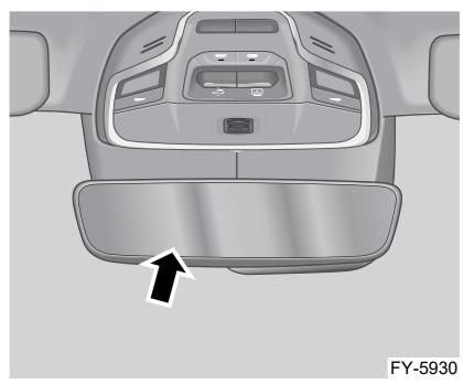
Внутреннее зеркало заднего вида определяет интенсивность попадающего на него света с помощью датчика освещенности и активирует электронную функцию затемнения.
