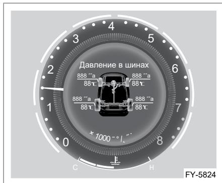
Датчики давления в шинах передают показания давления и температуры в шинах на комбинацию приборов; эти значения отображаются на дисплее комбинации приборов в режиме реального времени. Точность показаний температуры в шине составляет около 1 °C, а показаний давления в шине около — 1 кПа.
