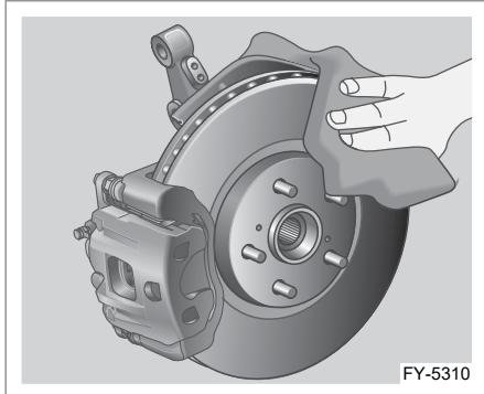
9. Очистите колесные болты, монтажные поверхности и запасное колесо от ржавчины и грязи.
