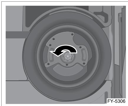
Если автомобиль оборудован сабвуфером, откройте декоративную панель багажника, отсоедините разъем жгута проводов сабвуфера, поверните сабвуфер против часовой стрелки, пока он не освободится, и снимите прижимную пластину, чтобы вынуть запасное колесо.
