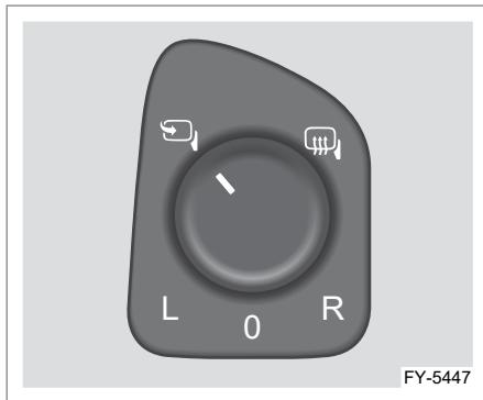
Когда пусковой переключатель находится в режиме ON, можно одновременно сложить левое и правое зеркала заднего вида, для чего необходимо повернуть ручку переключателя регулировки наружных зеркал заднего вида в положение  $\swarrow$ . Для раскладывания зеркал заднего вида поверните ручку переключателя в другое положение.
