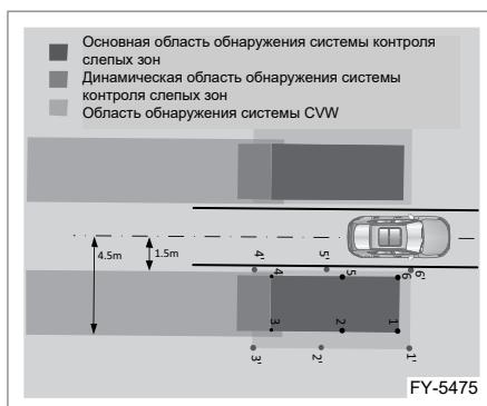
Основная зона срабатывания сигнала тревоги системы контроля слепых зон представляет собой многоугольную область, состоящую из 6 точек, при этом области слева и справа симметричны.
