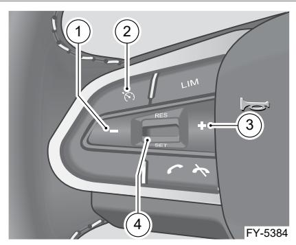
Выключатель круиз-контроля расположен в левой части рулевого колеса.
