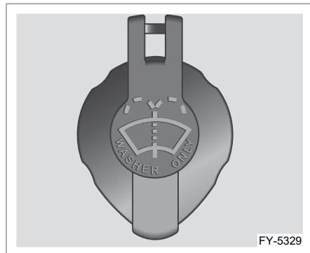
Откройте крышку заливной горловины с символом стеклоомывателя. Долейте омывающую жидкость в бачок до его заполнения. Для уточнения местоположения резервуара для жидкости см. раздел «Моторный отсек».
