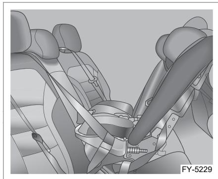
Детская колыбель, устанавливаемая против направления движения, обеспечивает защиту за счет плотного прилегания спинки колыбели к спине младенца. Система привязных ремней позволяет зафиксировать тело ребенка, поэтому в случае аварии ребенок надежно удерживается в устройстве.
