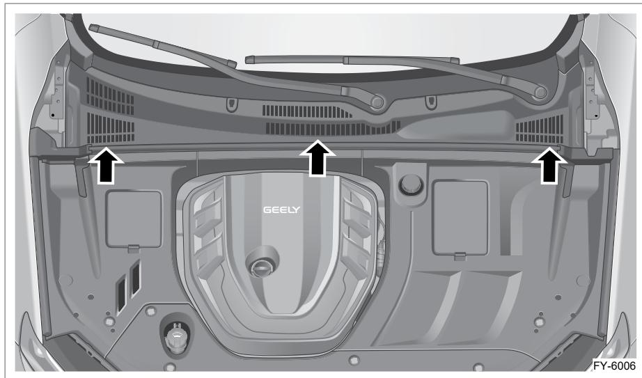
Удалите лед, снег или листья из канала воздухозаборника в нижней части ветрового стекла, чтобы улучшить прохождение воздуха в салон автомобиля.
