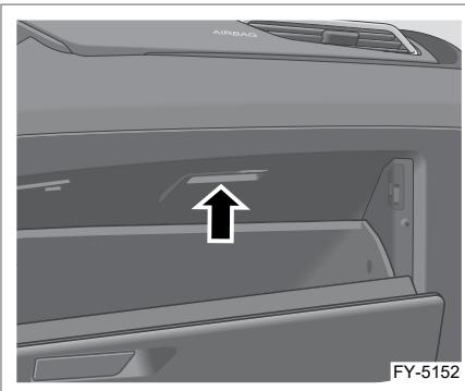
Лампа подсветки перчаточного ящика включается автоматически при открывании перчаточного ящика и выключается при его закрывании.
