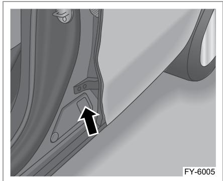
Заводская табличка автомобиля расположена под левой средней стойкой автомобиля и содержит следующую информацию:
