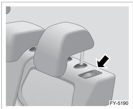
Кнопки фиксаторов расположены с обеих сторон спинки заднего сиденья, а замок ремня безопасности поворачивается
