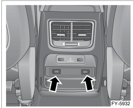
Выключатели обогрева заднего сиденья находятся на задней панели центральной консоли. При нажатии левой или правой кнопки включается обогрев подушки сиденья заднего ряда с соответствующей стороны. Нажмите кнопку снова, чтобы отключить обогрев.
