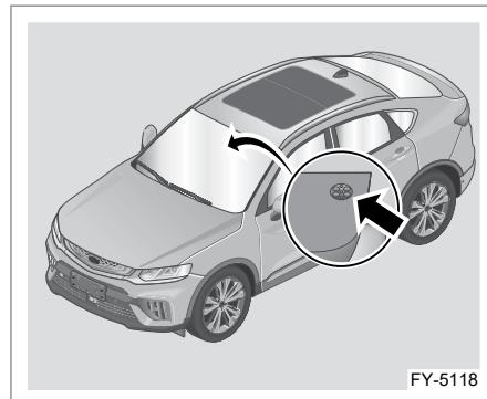
Датчик дождя, объединенный с датчиками наружного освещения и солнечного излучения, установлен позади внутреннего зеркала заднего вида. Он регулирует работу стеклоочистителей в соответствии с интенсивностью осадков, попадающих на ветровое стекло.
