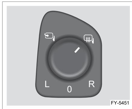
Электрообогрев наружных зеркал заднего вида может быть включен при запущенном двигателе: поверните ручку переключателя регулировки наружных зеркал заднего вида в положение  $\heartsuit$  или нажмите кнопку обогрева заднего стекла / наружных зеркал заднего вида на панели управления кондиционером.
