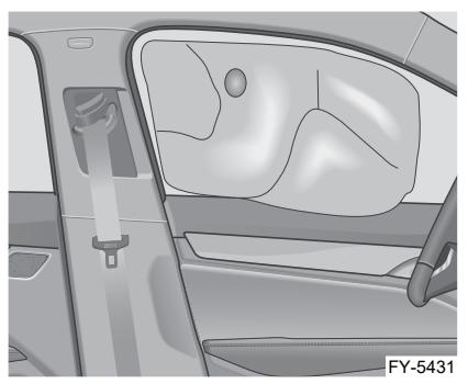
Боковые подушки безопасности и надувные шторки (при наличии) срабатывают при умеренном или сильном боковом ударе, когда ударное воздействие превышает определенный пороговый уровень. Это позволяет значительно снизить риск серьезного травмирования верхней части тела и таза при боковом ударе.
