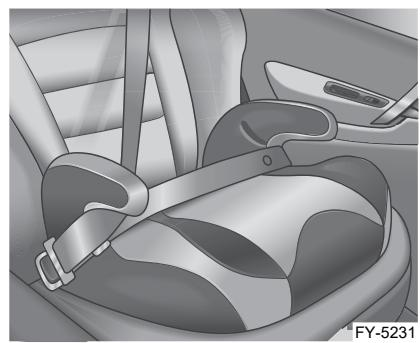
Подушка-бустер — это разновидность детского удерживающего устройства, которая предназначена для более безопасного использования штатных ремней безопасности автомобиля. Подушка-бустер также позволяет ребенку свободно смотреть в окно.
