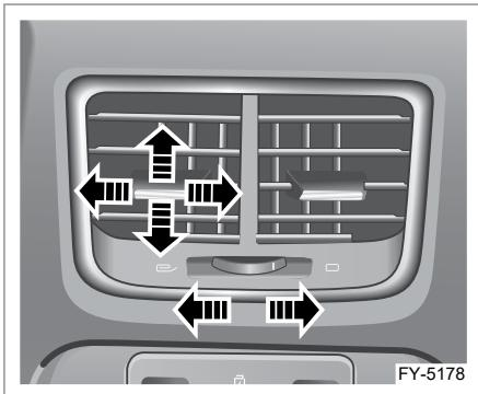
Объем воздуха, подаваемого через задний вентиляционный воздуховод, можно регулировать, поворачивая дисковый регулятор влево и вправо. Объем воздуха будет уменьшаться при повороте дискового регулятора влево (до полного закрытия) и увеличиваться при повороте дискового регулятора вправо (до достижения максимального объема). Направление воздушного потока можно регулировать, меняя положение решетки (вверх/вниз, влево/вправо).
