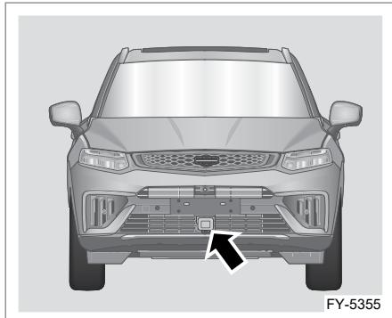
Датчик, используемый системой ACC: радиар среднего радиуса действия.
