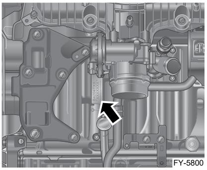
Код двигателя JLH-4G20TDB выбит на блоке двигателя под впускным коллектором (номер виден с передней стороны автомобиля).
