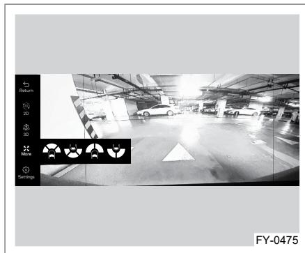
Многоэкранный режим просмотра включает 4 вида: широкоугольный обзор на 180° спереди, широкоугольный обзор на 180° сзади, вид спереди с двух сторон и вид сзади с двух сторон.
