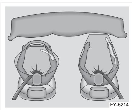
В случае столкновения блок управления подушками безопасности определяет интенсивность замедления автомобиля и принимает решение о необходимости раскрытия подушек безопасности. Срабатывание подушек безопасности в большей степени зависит от природы объекта, с которым произошло столкновение, интенсивности замедления автомобиля и
