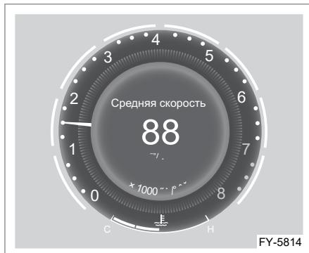
Показания тахометра можно использовать для выбора момента переключения передач (в ручном режиме) и предотвращения перегрузки или чрезмерного повышения оборотов двигателя.
