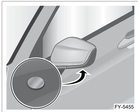
Лампы подсветки дверных порогов находятся на наружных зеркалах заднего вида. Когда пусковой переключатель находится в состоянии OFF, а автомобиль заперт, и вы разблокируете двери автомобиля с пульта дистанционного управления, наружные зеркала заднего вида раскладываются и включаются лампы подсветки дверных порогов. Когда пусковой переключатель переводится в другой режим или наружные зеркала заднего вида складываются, лампы подсветки дверных порогов выключаются.
