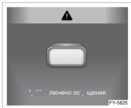
Когда пусковой переключатель находится в режиме OFF, габаритные огни включены и открывается дверь водителя, то на дисплее комбинации приборов появится предупреждение о том, что световые приборы не выключены, и прозвучит зуммер, чтобы не допустить разрядку аккумуляторной батареи.
