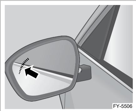
Предупреждающие индикаторы системы контроля слепых зон установлены на левом и правом наружных зеркалах заднего вида.
