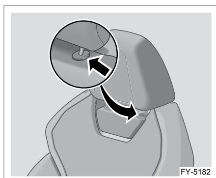
Чтобы поднять или опустить подголовник, нажмите и удерживайте кнопку фиксатора, расположенную сбоку от подголовника. Поднимите или опустите подголовник на нужную высоту, а затем отпустите кнопку. Плавно нажмите или потяните подголовник вниз до характерного щелчка, чтобы убедиться в надежности фиксации.
