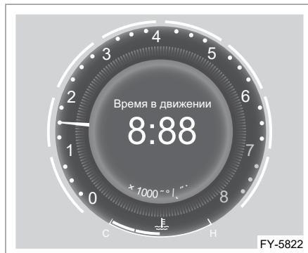
Когда маршрутный компьютер определяет, что двигатель работает, запускается отсчет времени в пути; когда двигатель останавливается, отсчет времени прекращается. Время в пути обнуляется при полном прекращении подачи питания к комбинации приборов.
