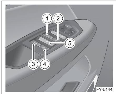
1. Переключатель электрического стеклоподъемника передней левой двери
