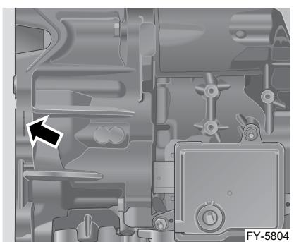
Код 8-ступенчатой автоматической коробки передач расположен на картере коробки передач в моторном отсеке рядом с двигателем (номер виден с передней стороны автомобиля).
