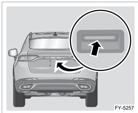
Если при припаркованном автомобиле нажать внешнюю кнопку отпирания двери багажного отделения в течение 30 секунд после отпирания дверей или после нажатия кнопки отпирания двери багажного отделения на смарт-ключе, дверь багажного отделения откроется автоматически.
