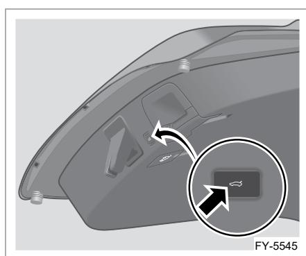
Если автомобиль оснащен электроприводом двери багажного отделения, нажмите кнопку закрывания на нижнем торце двери багажного отделения, после чего дверь закроется автоматически. Нажмите кнопку закрывания снова во время закрывания двери багажного отделения, чтобы остановить дверь багажного отделения.
