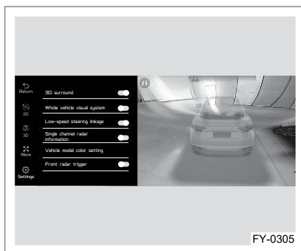
Синхронизация с рулевым управлением осуществляется в зависимости от скорости. Настройки можно выполнить в интерфейсе мультимедийной системы.
