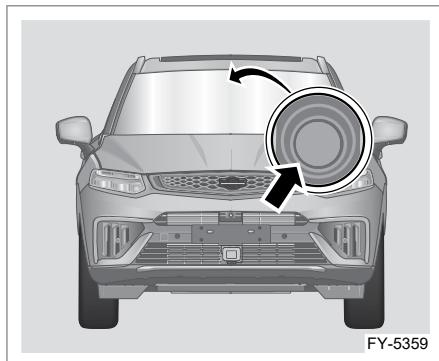
Датчик, используемый системой IHBC: фронтальная камера.
