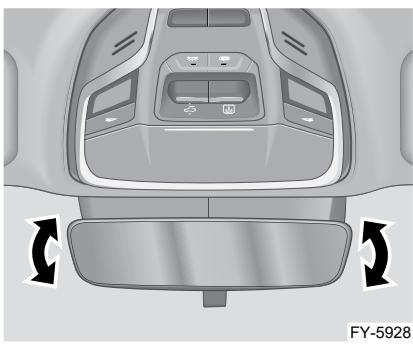
Внутреннее зеркало заднего вида закреплено на ветровом стекле, его положение можно отрегулировать для обеспечения необходимого обзора пространства позади автомобиля.
