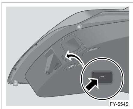
Открыв дверь багажного отделения на определенную высоту, нажмите и удерживайте переключатель на двери багажного отделения; после успешного запоминания высоты прозвучит звуковой сигнал. В следующий раз, когда дверь багажного отделения будет открываться, она откроется на установленную высоту.
