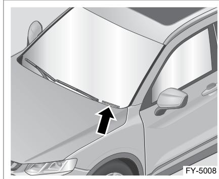
Номер VIN, изображенный на рисунке, находится на приборной панели в нижнем левом углу ветрового стекла\*.
