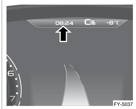
Часы отображаются в верхней центральной части дисплея комбинации приборов.\*
