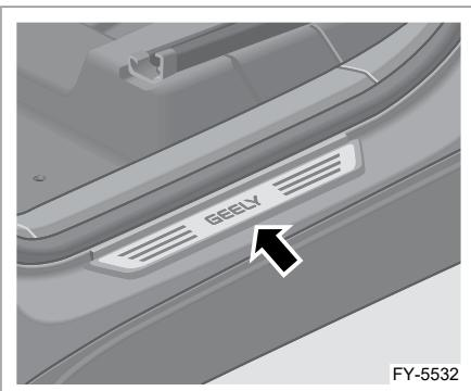
Лампа подсветки подножки расположена на пороге передней двери. Лампа подсветки подножки загорается автоматически при открывании передней двери, и автоматически гаснет после ее закрывания.
