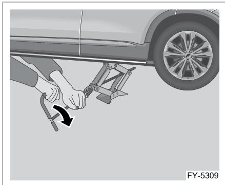
6. Поверните ручку домкрата по часовой стрелке, как показано на рисунке. Поднимите автомобиль на достаточную высоту от земли для установки запасного колеса.
