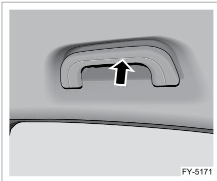
В салоне автомобиля предусмотрены потолочные поручни, расположенные со стороны переднего пассажирского сиденья и по обеим сторонам заднего сиденья. Пассажиры могут пользоваться поручнями в случае необходимости. Потолочные поручни снабжены пружинными креплениями. При отпускании поручень автоматически возвращается в исходное положение.
