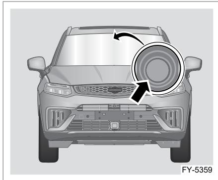
Датчик, используемый системой LKA: фронтальная камера.
