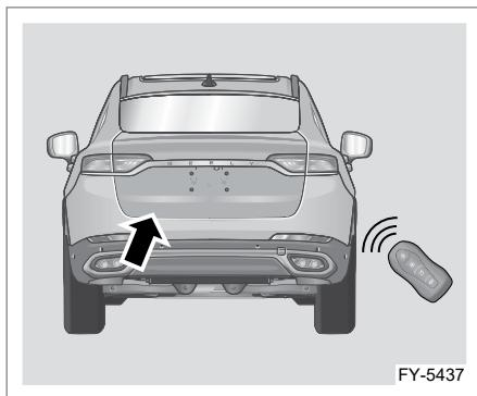
Когда пусковой переключатель находится в режиме OFF, а дверь багажного отделения закрыта, нажмите и удерживайте кнопку отпирания двери багажного отделения на смарт-ключе, после чего дверь багажного отделения откроется автоматически. Когда пусковой переключатель находится в режиме OFF, а дверь багажного отделения открыта (больше, чем на 10%), нажмите и удерживайте кнопку отпирания двери багажного отделения на смарт-ключе, после чего дверь багажного отделения закроется автоматически.
