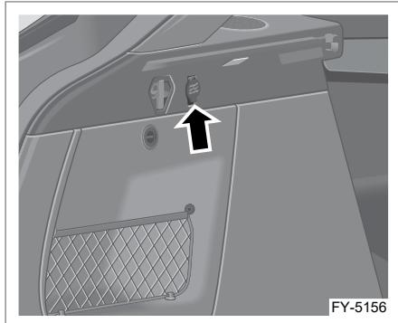
Электрическая розетка может использоваться для подключения электроприборов с максимальной потребляемой мощностью не более 120 Вт. Передняя электрическая розетка расположена с левой стороны под центральной консолью; некоторые модели оборудованы электрической розеткой, расположенной на левой декоративной накладке багажного отделения.
