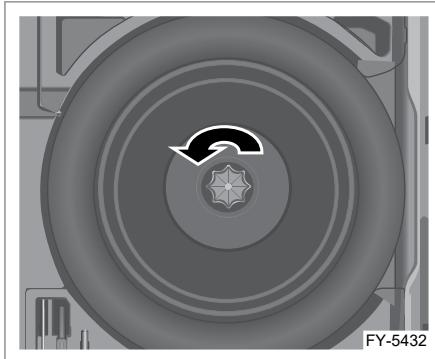
Запасное колесо хранится под набором инструментов в багажнике. Откройте декоративную панель багажника, достаньте набор инструментов и ослабьте блокировочную рукоятку, чтобы снять запасное колесо.
