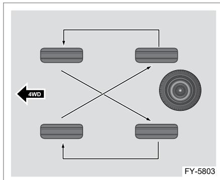
Для этого обязательно переставляйте колеса надлежащим образом, как показано на рисунке. После перестановки отрегулируйте давление в шинах передних и задних колес в соответствии со значениями давления, представленными в табличке, закрепленной на кузове автомобиля. См. раздел «Давление в шинах» настоящей главы.
