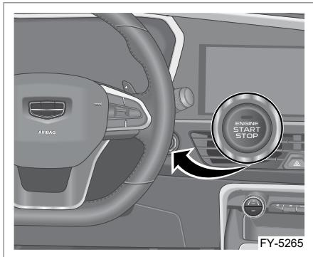
Ваш автомобиль оснащен электронным пусковым переключателем кнопочного типа для бесключевого запуска двигателя. Для работы системы необходимо, чтобы действительный смарт-ключ находился внутри автомобиля и определялся системой. Состояние ON/OFF пускового переключателя:
