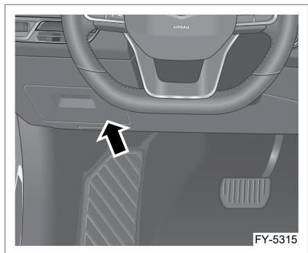
Блок предохранителей в салоне расположен в левой части приборной панели. Предохранители можно проверить, сняв отсек для хранения с приборной панели.
