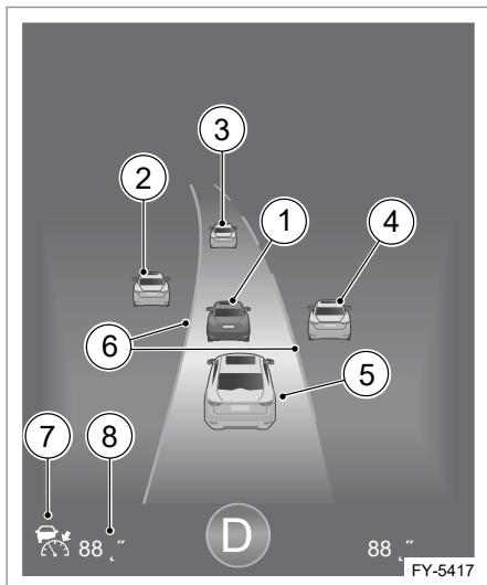
Идущий впереди автомобиль (1): серый, когда система ICC не активирована; синий, когда система ICC активирована; красный, когда система ICC активирована, и идущий впереди автомобиль находится слишком близко к вашему автомобилю; Идущий впереди автомобиль (2/3/4): синий, когда система ICC не активирована; белый, когда система ICC активирована; не отображается, если система ICC неисправна;
