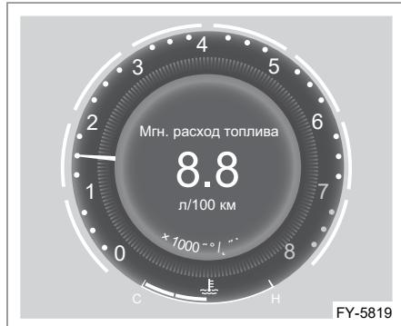
Мгновенный расход топлива отображается в л/100 км. Значение мгновенного расхода топлива не может быть сброшено. На холостом ходу отображается «—. —/100 км»;
