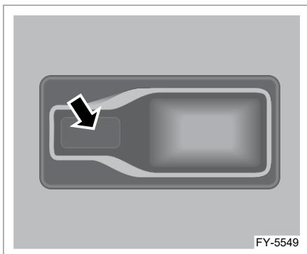
Нажмите выключатель заднего плафона освещения салона, чтобы включить или выключить плафон с соответствующей стороны.
