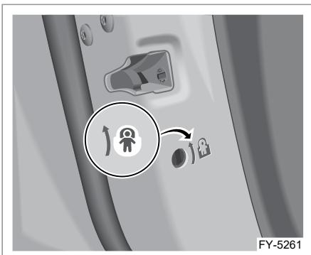
Задние двери автомобиля оснащены устройством защиты от открывания детьми. Если на левом или правом заднем сиденье находится ребенок, следует задействовать предохранительные устройства. Устройства защиты от открывания дверей детьми находятся на наружных боковых краях задних дверей. Вставьте механический ключ в предохранительное устройство и поверните его в направлении стрелки (см. рисунок). Предохранительное устройство будет переведено в по-
