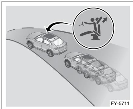
Функция предупреждения о наезде сзади работает на передаче P/N/D, и автомобиль не скатывается назад. Обнаружение приближающихся сзади целей включает в себя следующие цели:
