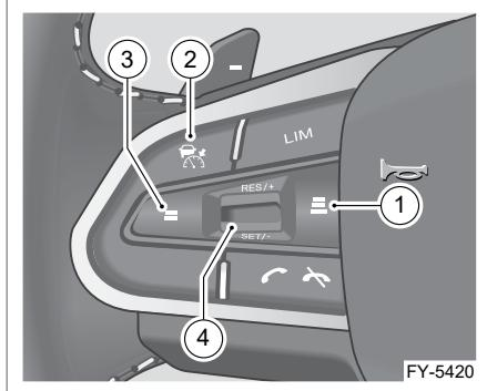
Кнопки управления системой ICC расположены в левой части рулевого колеса.
